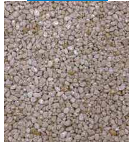
Thi công bằng hỗn hợp cốt liệu tự nhiên + Mapecrete I 910
